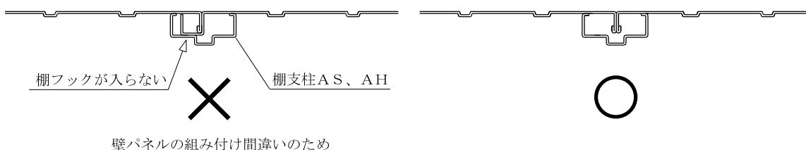
壁パネルの組み付け間違いのため
